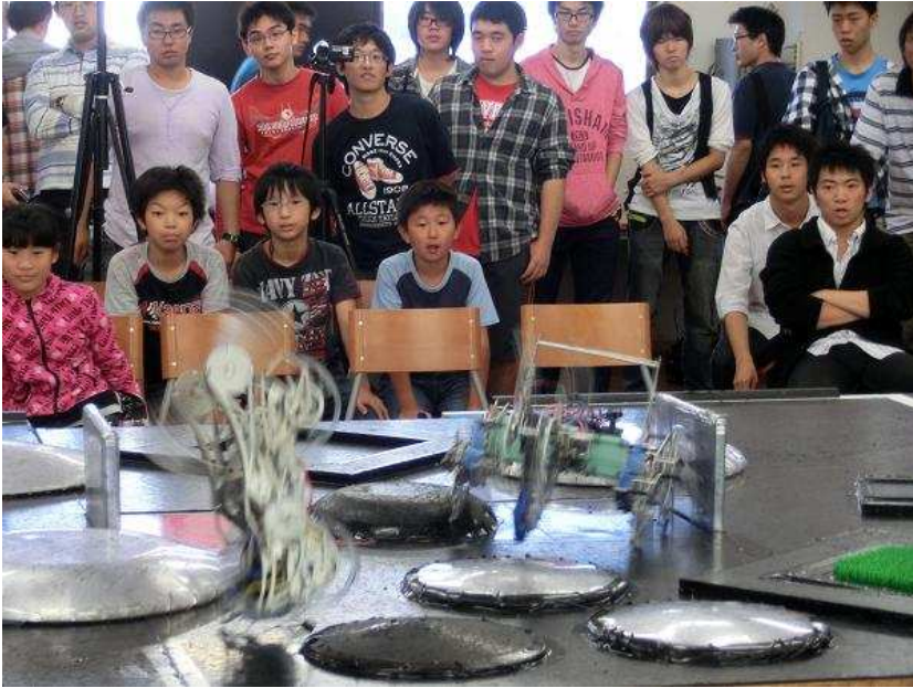
相手ロボットを吹き飛ばす強力なアームを備えています
