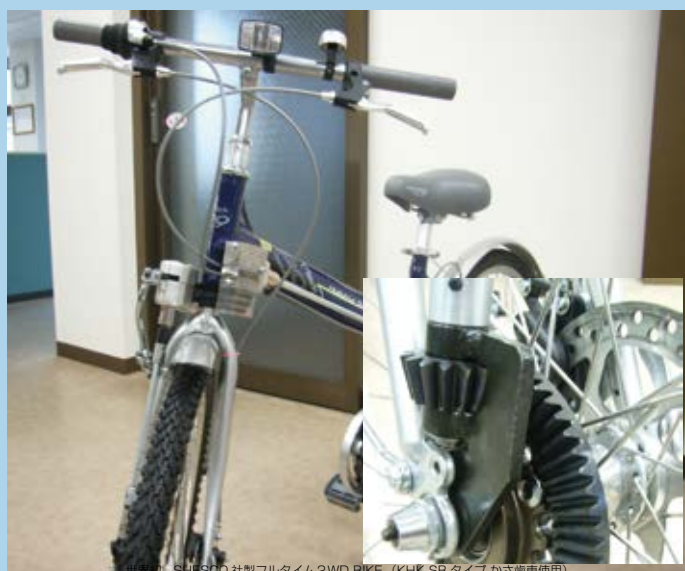
SHESDO 社製フルタイム2WD BIKE (KHK SB タイプ かみ歯車使用)
