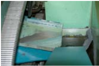
安裝防油罩，改善切削油飛濺及漏油問題。
