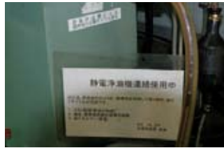
使用靜電淨油機對潤滑油和作業用油予以淨化。
