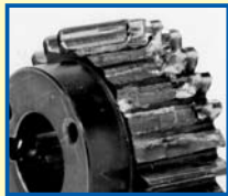
由於彎曲強度不足而造成的損壞例
