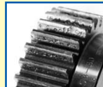
由於面壓強度不足而造成的磨損例
