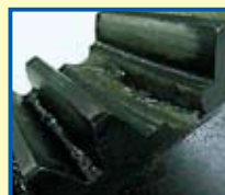
由於彎曲強度不足所造成的損壞例
